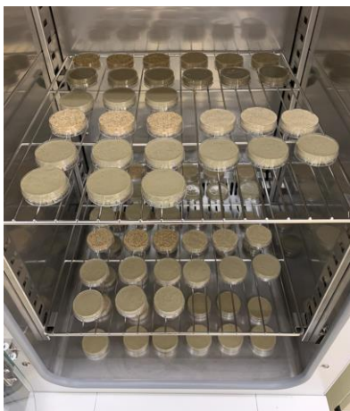
<다양한 입도의 토양에 MICP를 적용한 모습>
