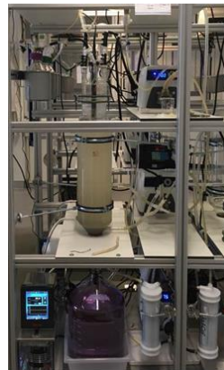
<헥사노익산 CSTR 반응조 모식도 Angenent group과의 공동연구 중 제작한 반응조>
