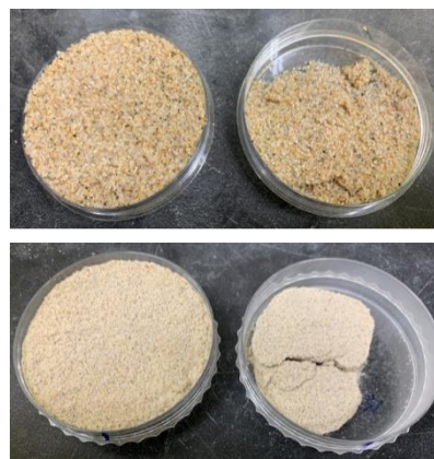
<바람에 노출시킨 후 (좌) MICP를 적용한 토양과 (우) 적용하지 않은 토양의 모습>
